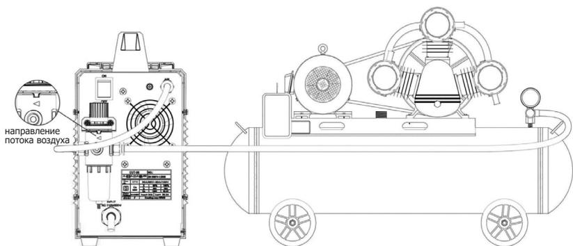
Регулярно сливайте воду из регулятора. Примечание: когда уровень воды достигнет двух третей чаши водяного фильтра, необходимо слить воду, в противном случае пострадает качество резки. При сливе воды закройте клапан подачи воздуха, выберите на панели аппарата функцию проверки воздуха. Когда значение давления воздуха на регуляторе будет равно нулю, вода стечет из сливного отверстия.
